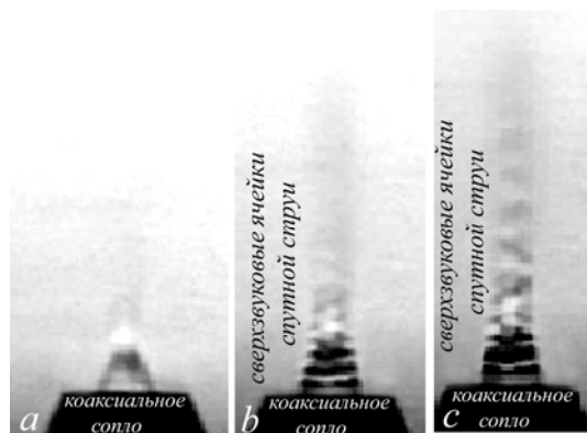
Рис. 4. Теневые картины сверхзвукового истечения коаксиальной (спутной) струи воздуха при наличии сверхзвуковых ячеек с ростом скорости истечения U_0 ( a, b, c ) = 290, 315, 350 м/с)
