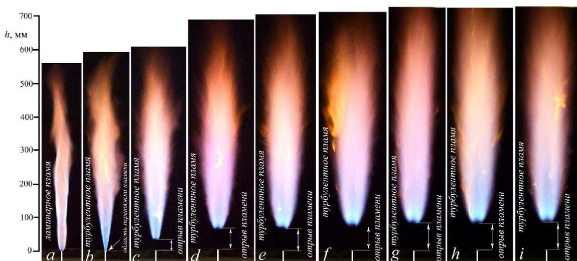
Рис. 11. Фотографии пламени при диффузионном горении микроструи водорода, истекающей из круглого ( $d = 1,5$  мм) сопла в ситуации нарастания скорости ее истечения от 40 до 1340 м/с
