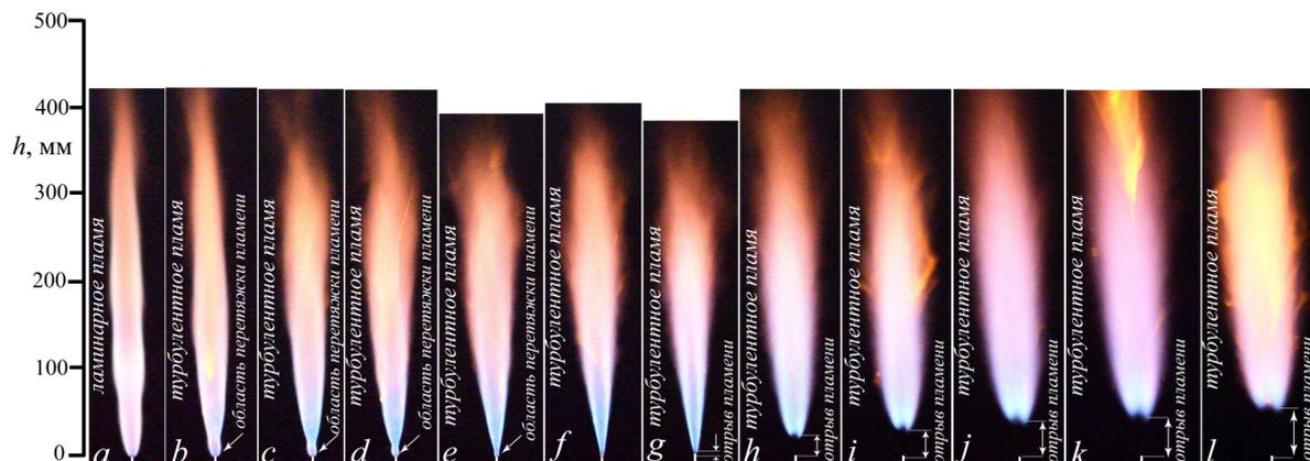
Рис. 2. Фотографии пламени при диффузионном горении микроструи водорода, истекающей из круглого ( $d = 1,2$  мм) сопла в ситуации нарастания скорости ее истечения:  $a-h$  – от 40 до 1340 м/с
