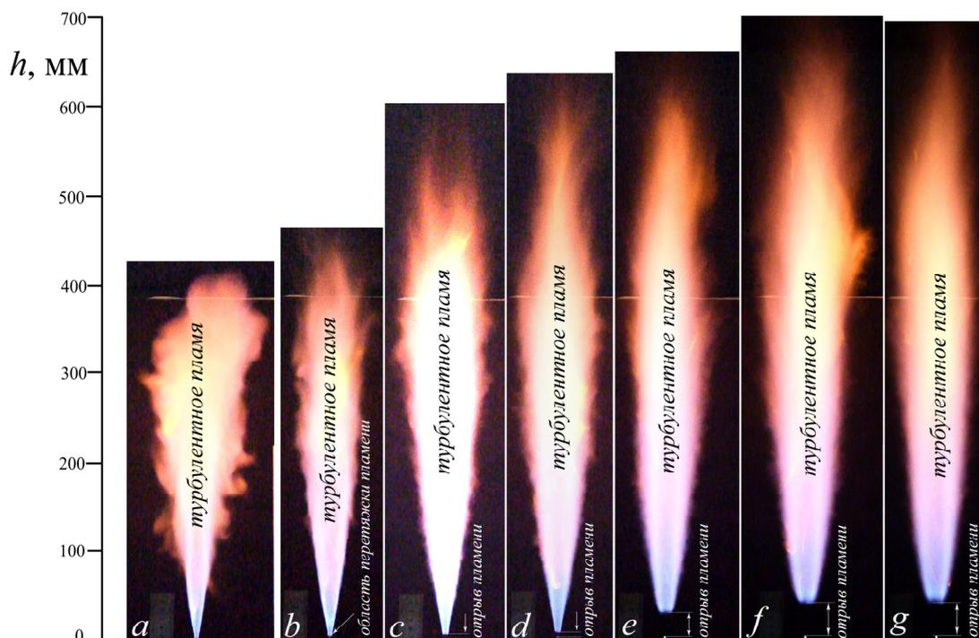
Рис. 16. Фотографии пламени при диффузионном горении микроструи водорода, истекающей из круглого ( $d = 2,7$  мм) сопла в ситуации нарастания скорости ее истечения:  $a-g$  – от 40 до 1340 м/с
