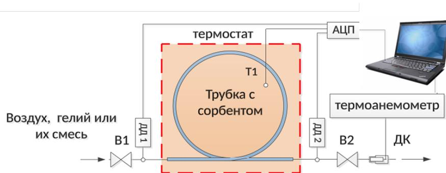
Рис. 8. Предлагаемая схема экспериментального стенда
