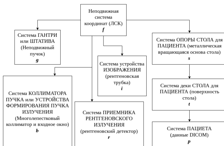
Рис. 8. Иерархическая структура систем координат ГОСТ Р МЭК 61217-2013 в приложении к РБС
