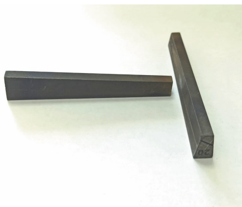
Рис. 7. Фотография отдельных сегментов постоянных магнитов
