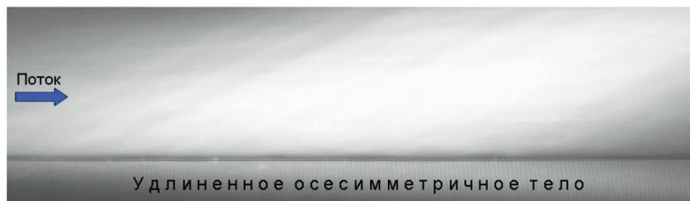
Рис. 4. Типичная визуализация пристенной области течения при наличии вдува через перфорированную поверхность
