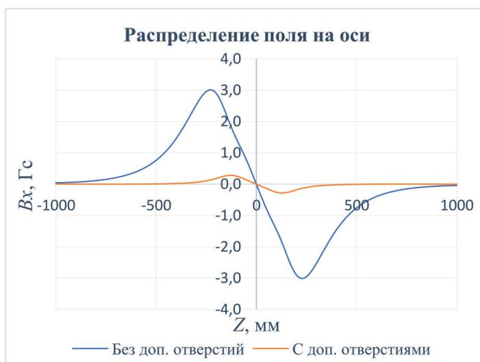
Рис. 8. Поперечное поле на оси соленоид предускорителя до добавления симметричных отверстий и после
