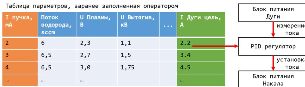
Рис. 3. Таблица параметров и логика PID-регулятора
