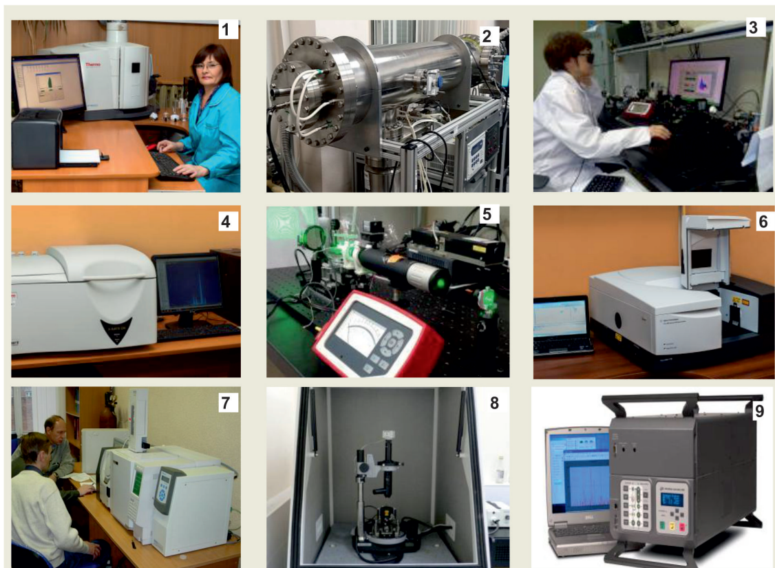
Рис. 10. Примеры оборудования ЦКП «Прикладная физика» НГУ: 1 – атомно-эмиссионный спектрометр с индуктивно связанной плазмой iCAP-6200DUO; 2 – времяпролетный масс-спектрометр RTOF-300; 3 – стенд контроля оптической однородности и степени монодоменности в кристаллах КТР, ВВО, РТР; 4 – рентгенофлуоресцентный энергодисперсионный спектрометр ARLQuant’X; 5 – стенд контроля контраста электрооптических модуляторов; 6 – ИК-Фурье спектрометр Cary600FTIR; 7 – хроматомасс-спектрометр GCMS-P2010Plus; 8 – атомно-силовой микроскоп НаноЛаборатория ИНТЕГРА Прима; 9 – универсальный газовый анализатор UGA-200
