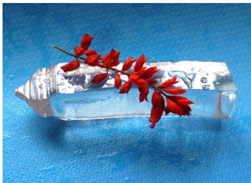
Рис. 7. Кристалл \text{CdWO}_4 , выращенный низкоградиентным методом Чохральского Fig. 7. \text{CdWO}_4 crystal grown by low-gradient Czochralskii method
