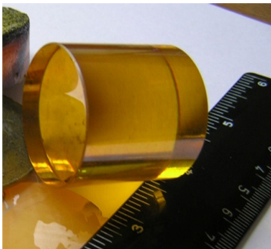
Рис. 8. Кристалл \text{ZnSe} и детектор нейтрино на его основе Fig. 8. \text{ZnSe} crystal and neutrino detector based on it
