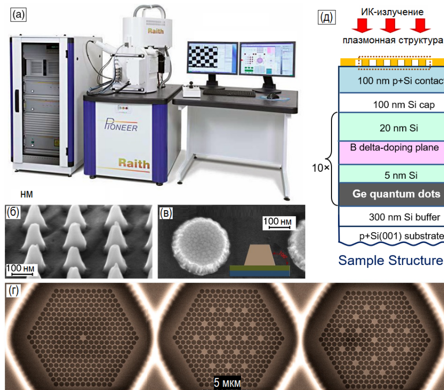
Рис. 7. (а) Установка Pioneer (RAITH) и РЭМ изображения двумерных регулярных структур Ge, выращенных и визуализированных с ее помощью: (б) конусообразные, (в) в форме диска; (г) двумерный фотонный кристалл, см. шкалу 5 мкм внизу; (д) гетероструктура образца с квантовыми точками Ge с перфорированной пленкой золота на поверхности Fig. 7. (a) Pioneer lithography apparatus (RAITH) and SEM images of two-dimensional regular Ge structures grown and visualized with its help: (b) cone-shaped, (c) disk-shaped. (g) 2D photonic crystal, see 5 \mu\text{m} scale below. (d) Heterostructures of a sample with Ge quantum dots with a perforated gold film on the surface
