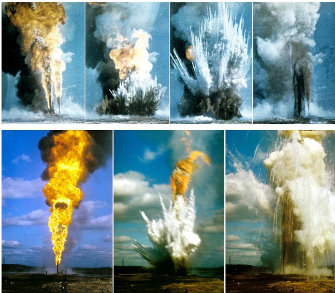
*Рис. 5. Примеры тушения пожаров на скважинах взрыво-порошковым способом*
