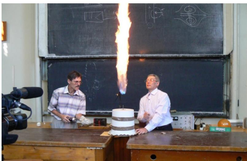
Рис. 7. В. А. Селезнёв, Е. И. Пальчиков. Тушение газового фонтана кольцевым вихрем
