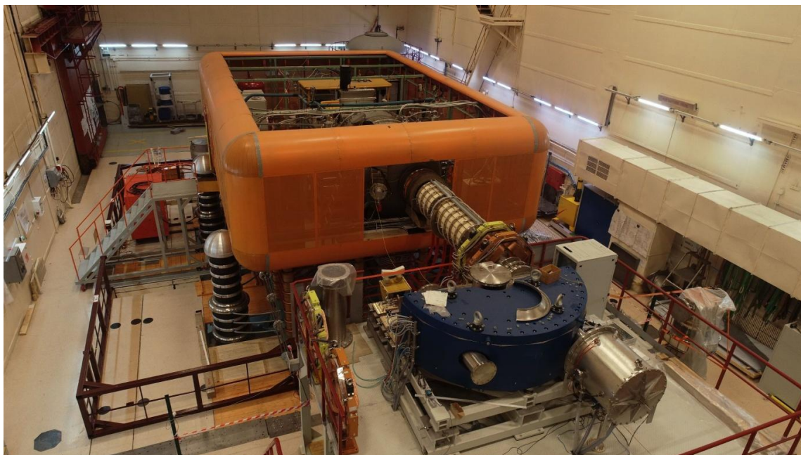
Стенд для испытаний инжектора пучка атомов водорода с энергией до 1 МэВ на основе отрицательных ионов Test site for hydrogen atom beam injector with energy up to 1 MeV based on negative ions
