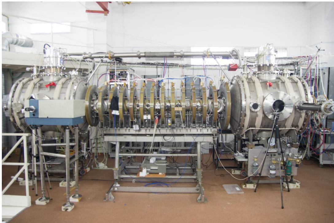
Установка СМОЛА для изучения течения плазмы в винтовом магнитном поле SMOLA facility for the study of plasma flow in a helical magnetic field
