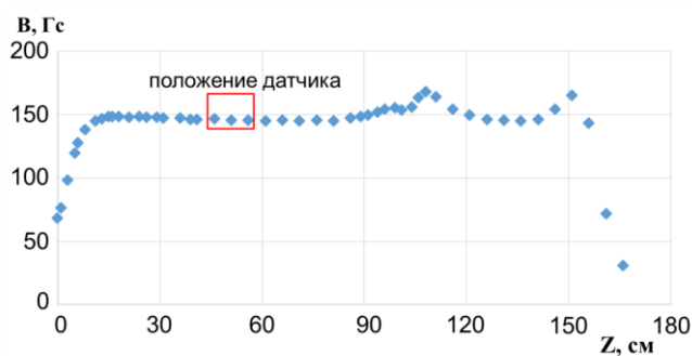
Рис. 8. Результат измерения распределения индукции магнитного поля вдоль оси верхнего канала
