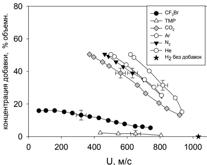
Рис. 4. Зависимость объемной концентрации добавок  $CF_3Br$ , ТМФ, He,  $N_2$ , Ar,  $CO_2$  в смеси с воздухом от скорости микроструи  $H_2$  ( $U$ ) в момент отрыва пламени
