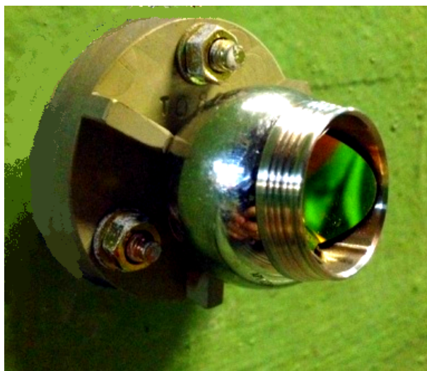
Рис. 3. Геодезический знак с установленным отражателем Fig. 3. Geodetic sign with installed reflector
