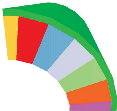
Рис. 3. Конфигурация магнитных секторов при задании метода конечных элементов в программе магнитостатики MERMAID (показана \frac{1}{4} симметрия)
