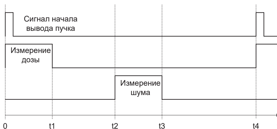
Рис. 3. Принцип работы контроллера ПТЧ Fig.3. Operating principle of the controller of the CFC
