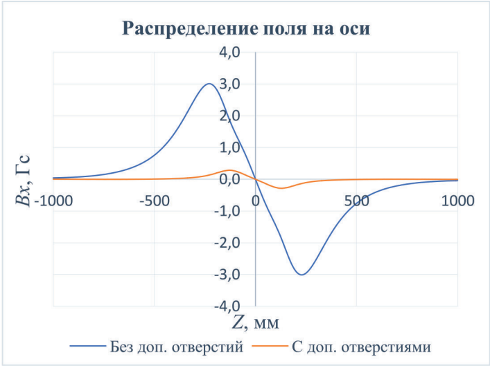
Рис. 8. Поперечное поле на оси соленоида предускорителя до добавления симметричных отверстий и после Fig. 8. Transverse field on the axis of the pre-accelerator solenoid before the addition of symmetrical holes and after
