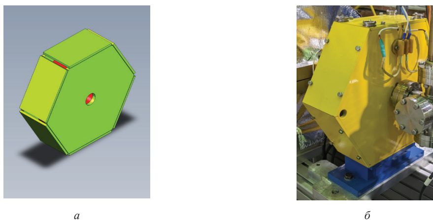
Рис. 5. Соленоид соленоида секции группировки: a – модель соленоида секции группировки; б – изготовленная линза
