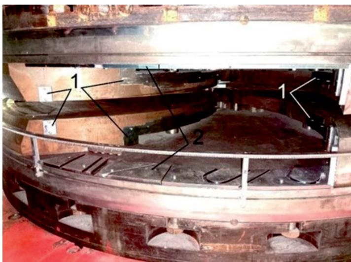
Рис. 6. Долинные шиммы (1), размещенные на полюсах, и боковые шиммы (2), установленные на секторах магнита У400М
