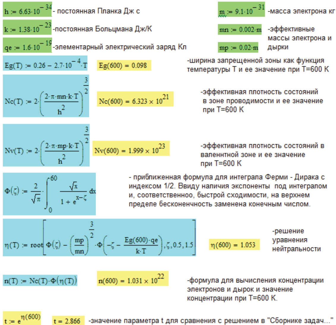
Рис. 8. Вычисление концентрации электронов и дырок в собственном полупроводнике с параболическими зонами Fig. 8. Calculation of the concentration of electrons and holes in an intrinsic semiconductor with parabolic zones
