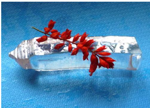
Рис. 7. Кристалл  $\text{CdWO}_4$ , выращенный низкоградиентным методом Чохральского
