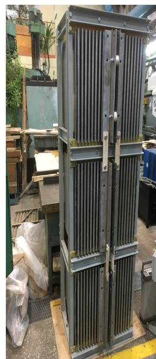
Рис. 8. Фотография изготовленного балластного резистора без корпуса
