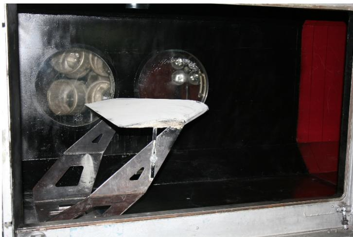
Рис. 2. Модель летающего крыла в рабочей части трубы
