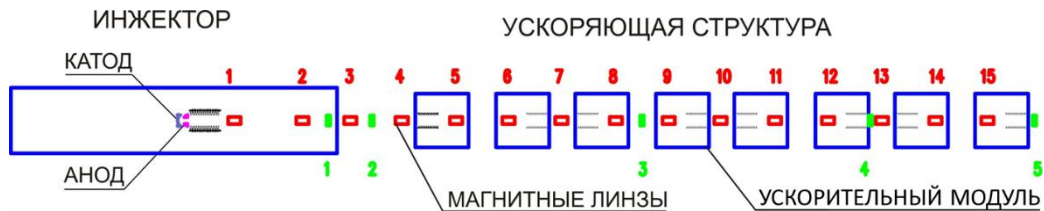
Рис. 1. Схема линейного индукционного ускорителя на энергию E_e = 5 МэВ. Синим цветом показаны корпуса ускорительных модулей и инжектора, красным – фокусирующие магнитные линзы, зеленым – датчики положения пучка в канале транспортировки, серым – ускоряющие трубки
