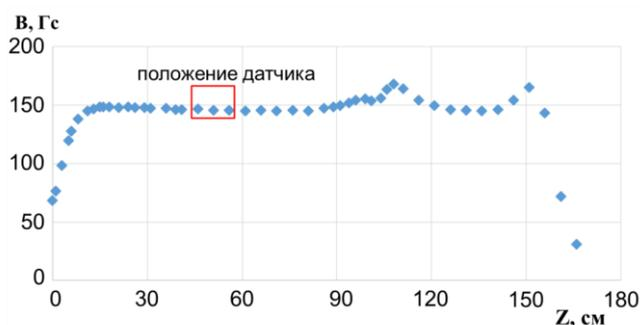
Рис. 8. Результат измерения распределения индукции магнитного поля вдоль оси верхнего канала
